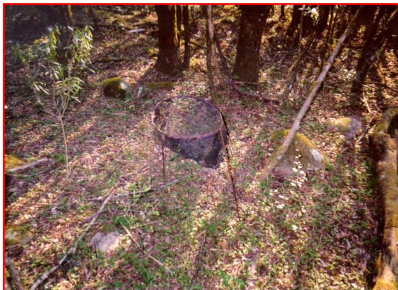
FIGURA 2: Aspecto de um dos coletores de serapilheira utilizado. Itaara, RS, Brasil.
