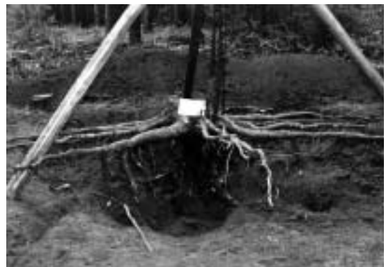
Figura 1. Izquierda: Exposición de las raíces, mediante excavación manual y mecánica. Derecha: trípode y tecla de cadena de 3 t.
